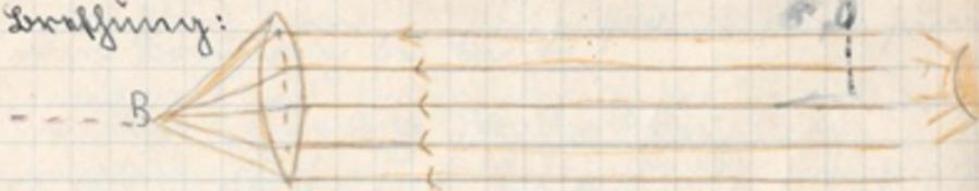
Parallel einfallende Lichtstrahlen werden durch die Linse so gebrochen, daß sie im Brennpunkt gepunktet werden. Die rechteckige Linse kann deshalb als Brennpunkt benutzt werden.
